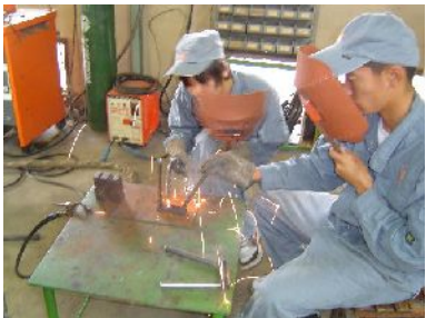
前輪固定用部品の溶接
