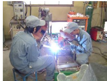
本体フロント部の溶接
